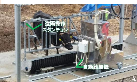
試験中の個体識別遠隔自動給餌システム(A).
