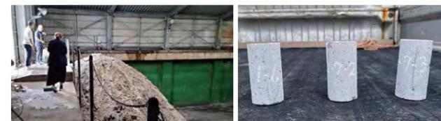
利用予定の焼却灰(屋内埋立処分場)と固形化試験体
